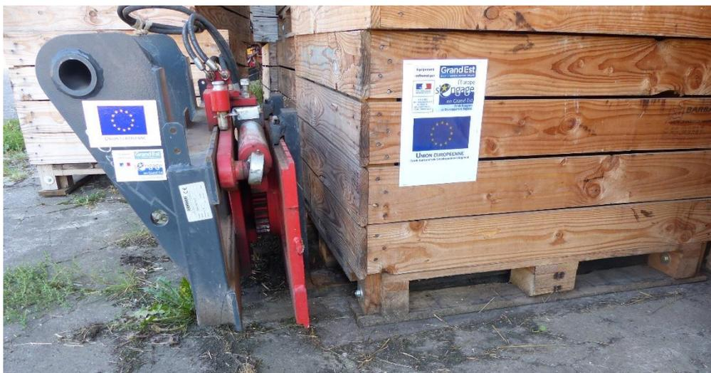
Cet équipement est complémentaire des palox car il permet leur manipulation notamment lors des différentes opérations de tri et de calibrage qui nécessitent de vider les palox petit à petit. Ainsi grâce à son équipement hydraulique, le retourneur de palox permet d'incliner ce dernier au fur et à mesure de l'opération de façon à ce que la vidange se fasse progressivement.
