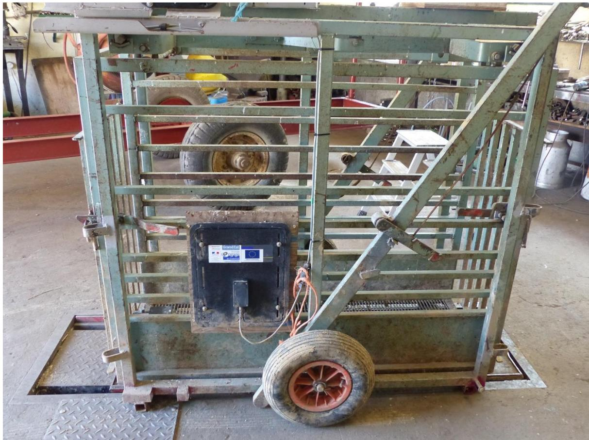
Composé d'un panneau RFID couplé à un boîtier identificateur, ce dispositif permet la lecture à distance des boucles électroniques d'identification des animaux. Jusqu'à présent, nous étions équipés de boîtiers de pesée sur lesquels la saisie de l'identification de chaque animal était réalisée manuellement par l'opérateur, ce qui était compatible pour des bovins avec le nombre d'animaux détenus.
